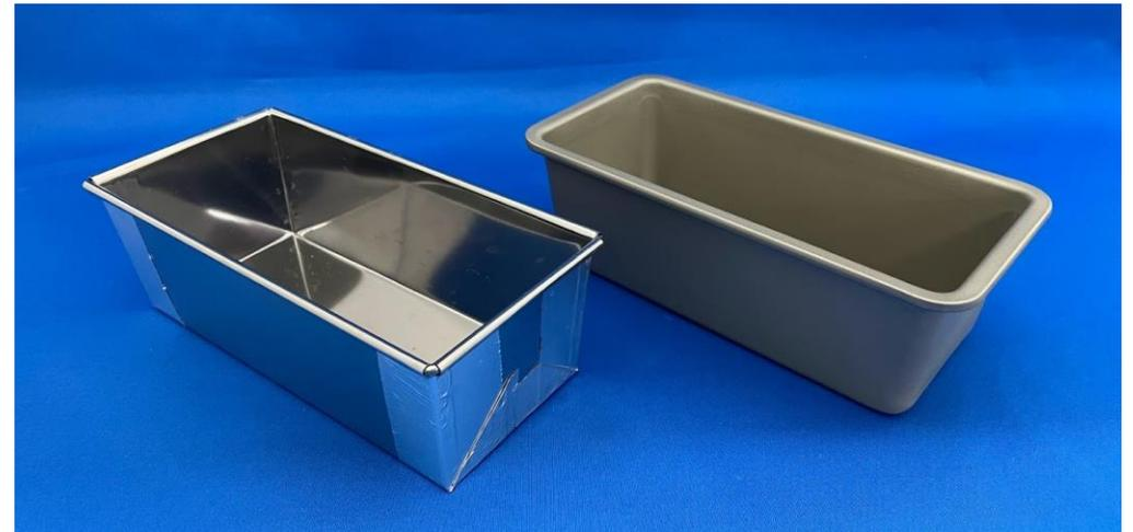
図16 アルミテープで補強した金属容器(左)と継ぎ目の無い金属容器(右)
