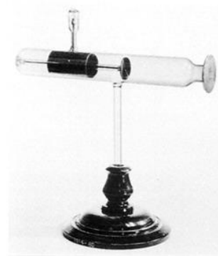
写真2. アルミニウム箔窓付レナルト管
