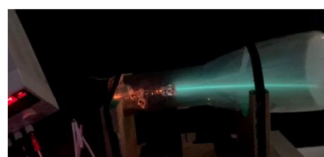
写真1 クルックス管の加速電圧 81 V の場合における電子線の様子：肉眼では線がよく見え、散乱は目立たない
