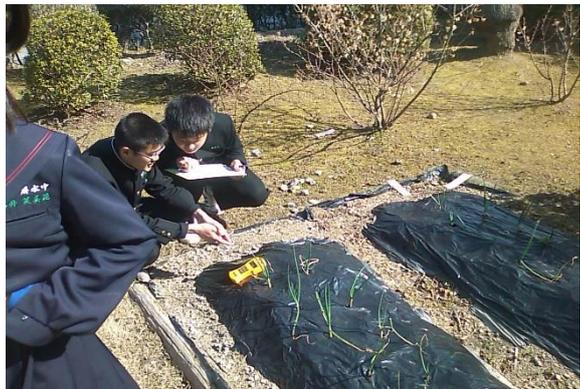
【図5】放射線カウンタを用いた測定
