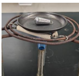
写真③ 鉛を溶かす様子
