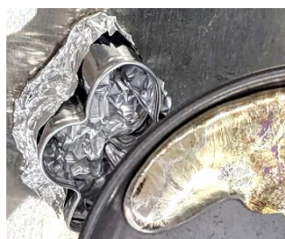
写真④ 溶かした鉛を抜型 に入れる様子
