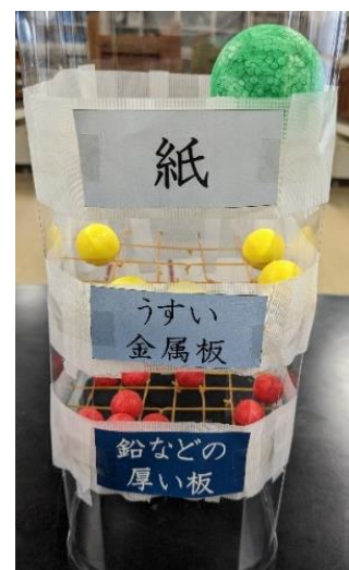
写真⑬ 遮蔽模型に各種放射線を入れた様子
