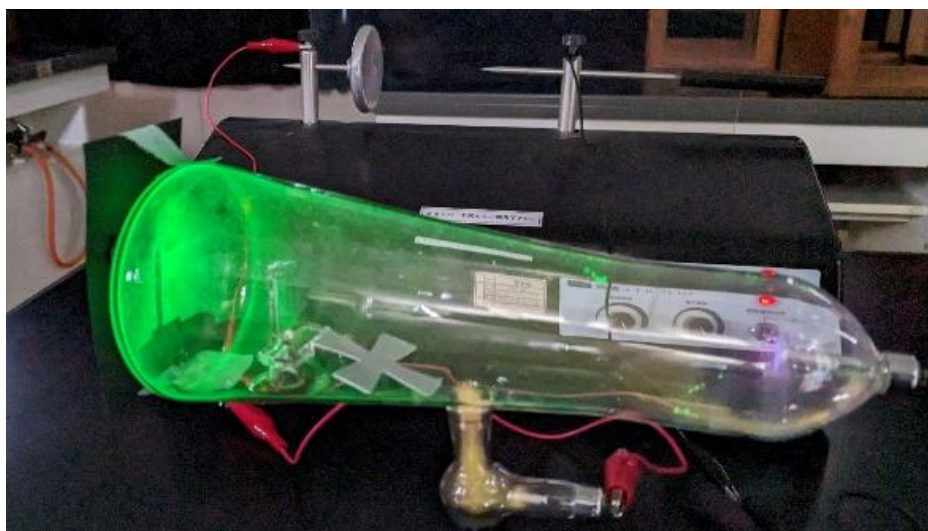
写真⑩ チェキフィルム入りの黒い封筒をクルックス管に貼り付けて放電している様子
