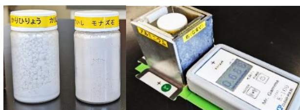
写真⑯ 放射線源と放射線源を遮蔽した放射線測定
