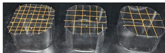
写真⑮ それぞれ格子幅の輪ゴムを取り付けたプラスチック
