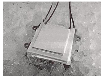
図1 2種類のペルチェ素子と塩化ナトリウムを加えた氷による冷却方法 1)
