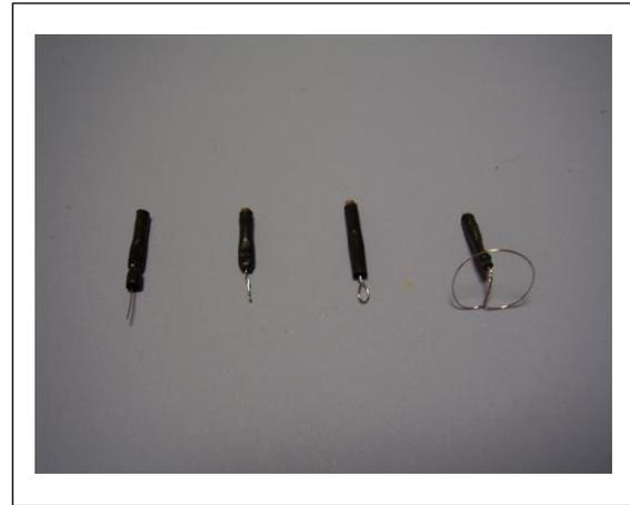
図-2 使用したアノードのユニット (左から、tip、0mm、2mm、10mm)
