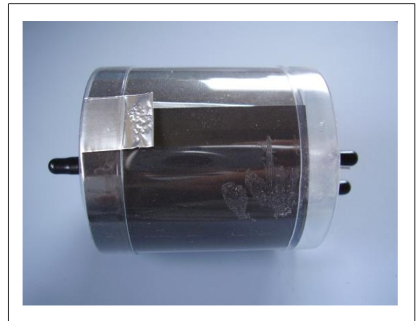
図-1 使用したクリアケース GM 管の全景
