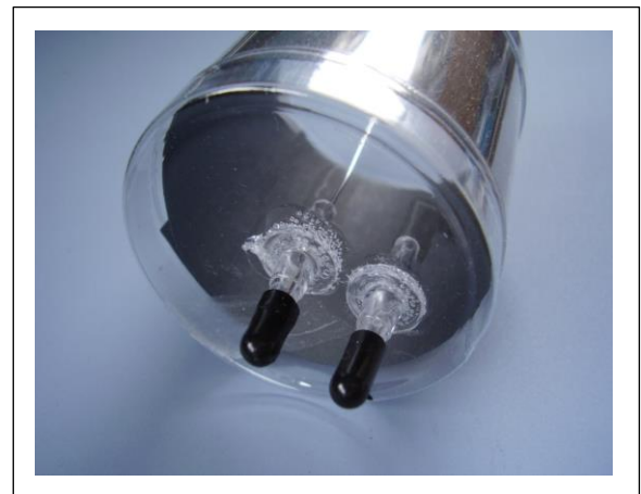
図-2 アノードとガス出入口ノズル
