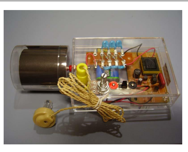
図-4 高圧電源とGM管の接続
