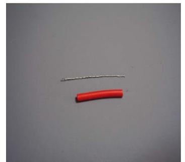
(2) ステンレス細線を手で二つ折りし、よじる。端部をラジオペンチで挟みながらよじり、先端のフープ径を 4mm 以下にする。先端から 5mm 以内には傷をつけないようにすること。
