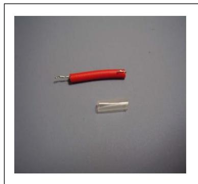
(4) 折り返したステンレス細線が露出しないように熱収縮チューブを外側に被せ、ライターであぶって密着させる。
