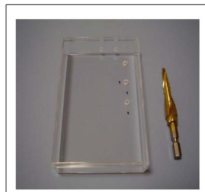
(4) 電動ドリルに取り付けたスパイラル・ドリル刃で、ピン・ジャック用の穴はφ6、RCA ジャック用の穴と可変抵抗器用の穴はφ7、スイッチ用の穴はφ9に拡大する。その後、面取り加工を行う。ケースは手持ちでよいが、ドリルは面に垂直となるように注意すること。φ9の穴をあける際は、過熱でプラスチックが溶けないように電動ドリルの回転数を少なめにする。要すれば、リーマーで仕上げ加工をすること。
