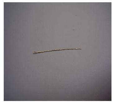
(3) よじったステンレス細線の端部から(1)のワイヤーの外被に通し、先端部が5mm程度露出するようにして端部を外被の外側に折り返す。
