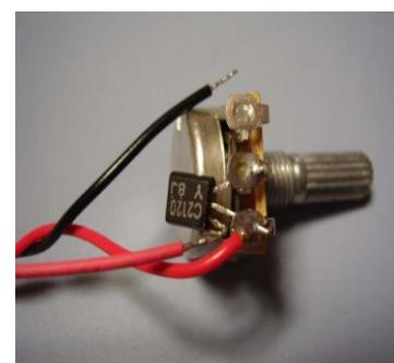
(15) 可変抵抗器の 1 番ピンに RCA ジャックに取り付けた 100k $\Omega$  抵抗の足を通し、ケースに固定してからはんだ付けする。100k $\Omega$  抵抗の足と RCA ジャックのグラウンド端子もはんだ付けする。
