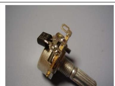
(14) 3 番ピンに電池スナップの赤のワイヤーをはんだ付けし、エミッターには用意してある赤のワイヤーの 8cm をはんだ付けする。
