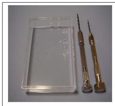
(6) スイッチ固定用の穴（貫通孔）2個は、現物合わせで、ピン・バイスに取り付けたφ2.5のドリル刃で開ける。
