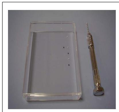
(3) ピン・ジャック用 2 個、RCA ジャック用、可変抵抗器用、スイッチ用の下穴 (貫通孔) を、電動ドリルに取り付けたスパイラル・ドリル刃の  $\phi 4$  で開ける。木片を使って支持し、ケースに力がかからないように注意して施工すること。
