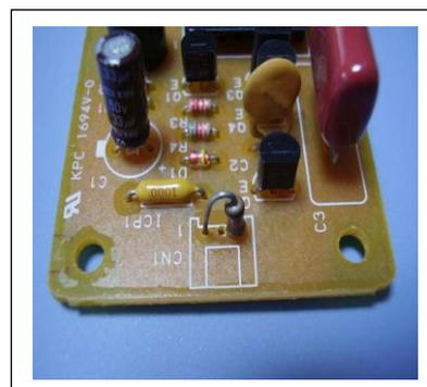
(4) 電源入力側のピン1とピン2（グラウンドのどこでもよい）間に、 $240\Omega$  の抵抗と LED を直列にはんだ付けする。まず、LED を基板の取り付け穴に通し、カソードの足を根元から曲げて近くのグラウンドのはんだ部にはんだ付けする。その後、 $240\Omega$  抵抗の足を  $7mm$  ほど残して切断し、一端をピン1のはんだ部にはんだ付けしてから、他端を LED のアノードの足の根元にはんだ付けし、余った足をそれぞれ切断して除く。
